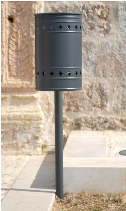
**Struttura:** Cestello realizzato in lamiera sagomata d'acciaio zincato sp. 10/10 con disegni di fiori disposti su due file, fondo in lamiera con fori per lo scolo delle acque piovane. Dimensioni del cestello cm 28 x 42 h. Palo di sostegno realizzato mediante tubo tondo d'acciaio Ø mm. 50 x 2 con all'apice copritesta alettato in PE. Sistema di svuotamento a ribalta mediante sgancio con chiave a brugola fornita in dotazione.
